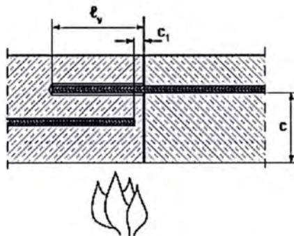
$$N_{Sd,fi} \leq (l_v - c_1) \cdot \phi \cdot \pi \cdot f_{bd,fi} \quad \text{mit } l_s \leq (l_v - c_1) \leq 80 \phi$$
